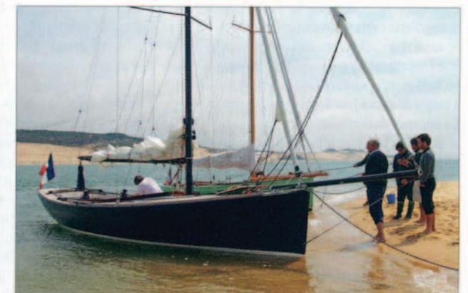
▲ Mât en aluminium laqué noir sur le Cap Cod, mât en spruce sur le Bô (que l'on distingue à l'arrière-plan); deux styles résolument différents.
