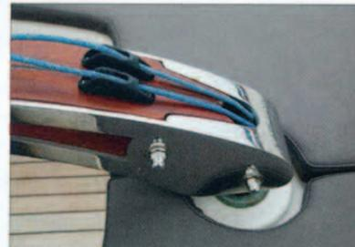
▲ Belle pièce inox au-dessus du palier supérieur de la barre. Notez les bouts de relevage du safran
